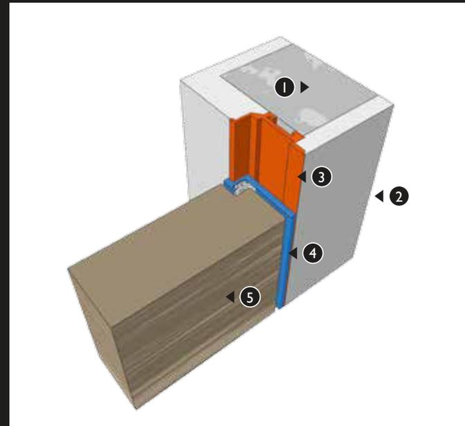
① Mauerwerk ② Putzoberfläche ③ Aluminium-Untertzarge ④ Aluminium-Deckzarge ⑤ 60 mm Türblatt
