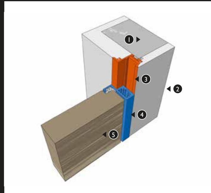
① Mauerwerk ② Putzoberfläche ③ Aluminium-Untertzarge ④ Aluminium-Deckzarge ⑤ 40 mm Türblatt
