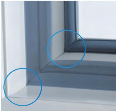
Die hochwertigen Dichtungen sind in den Ecken verschweißt. Spezielle Fertigungstechniken verhindern eine Verhärtung der Dichtungen im Eckbereich und sorgen somit für einen gleichmäßigen Anpressdruck über den gesamten Dichtungsverlauf.
