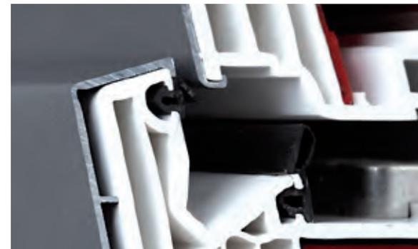
Die Wanddicke des Profils von 3 mm entspricht der höchsten Güteklasse Klasse-A. Die Aluminium-Vorsatzschale wird über passgenaue Führungen mit den Kunststoffprofilen verbunden.
