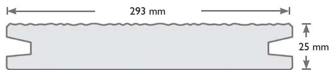
Strukturiert gehobelte Oberfläche,
